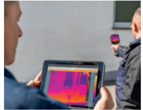
Die Wärmebildkamera überträgt die Bilder auch per App zur Analyse und Messberichterstellung vor Ort.
