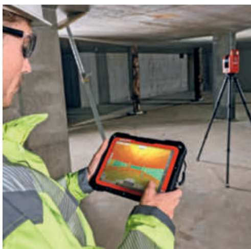
Der Laserscanner P3D 800 von Hilti unterstützt bei der 3D-Erfassung.
